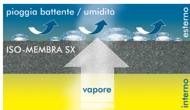
Principio di funzionamento membrana di tenuta
