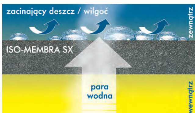
Zasada działania membrany uszczelniającej
