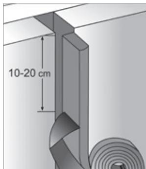
4. Dopo l'espansione, il nastro si fissa ai bordi del giunto. Le irregolarità vengono compensate dalla elasticità del nastro di tenuta.
