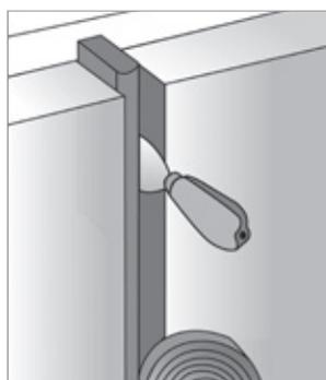
Premere con la mano o una spatola il lato adesivo contro la faccia del giunto o la superficie del componente e fissare il nastro. Continuare a staccare la striscia di copertura dal autoadesivo secondo l'avanzamento dei lavori.
